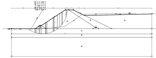
图 5-2 洪水运行计算结果简图
